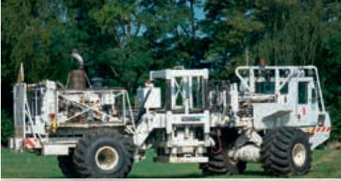
Vibro-Fahrzeug bei der Vermessung
