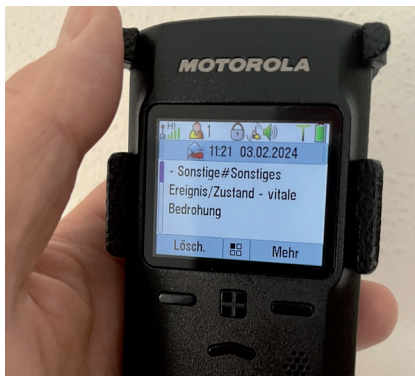
Abruf von Alarmstichwort und -adresse, direkt am neuen TETRA-Funkmelder
