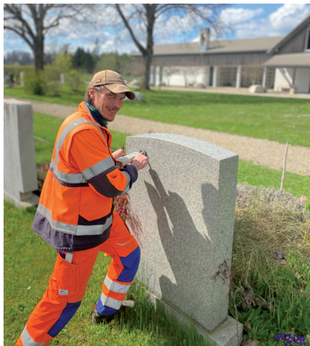
Unser Bauhofmitarbeiter prüft die Standssicherheit mit einem geeichten Gerät.
